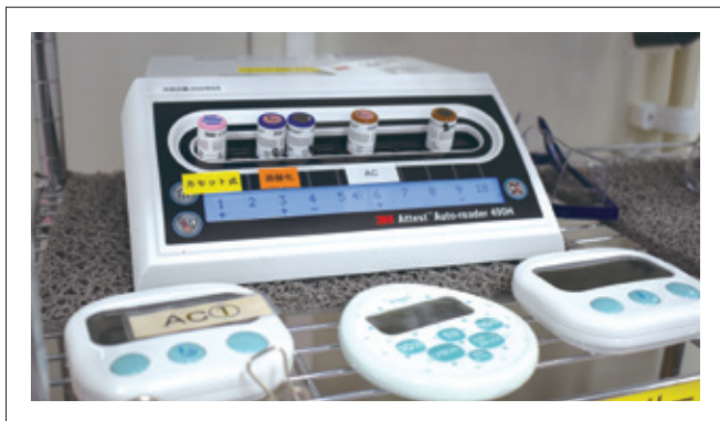
図1 3M™ アテスト™ オートリーダー 3種の滅菌法(蒸気滅菌、過酸化水素ガス滅菌、フラッシュ滅菌)が1台のオートリーダーで対応可能
