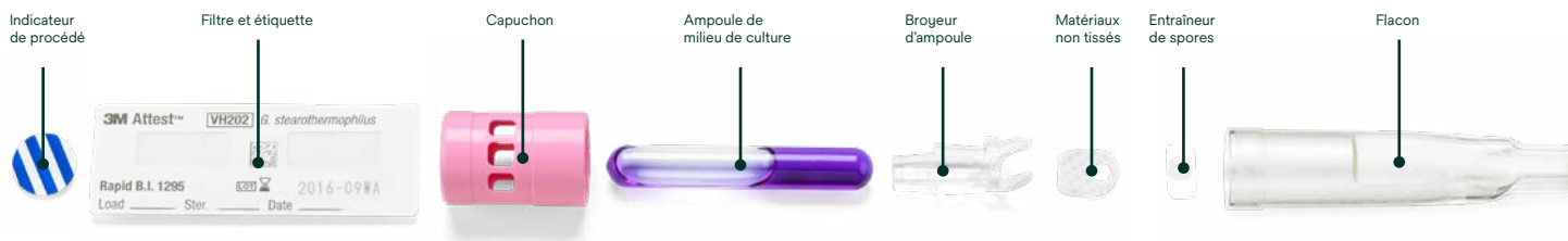
Figure 3. Schéma des composants de l'Indicateur biologique à lecture rapide 1295 Attest MC 3M MC
