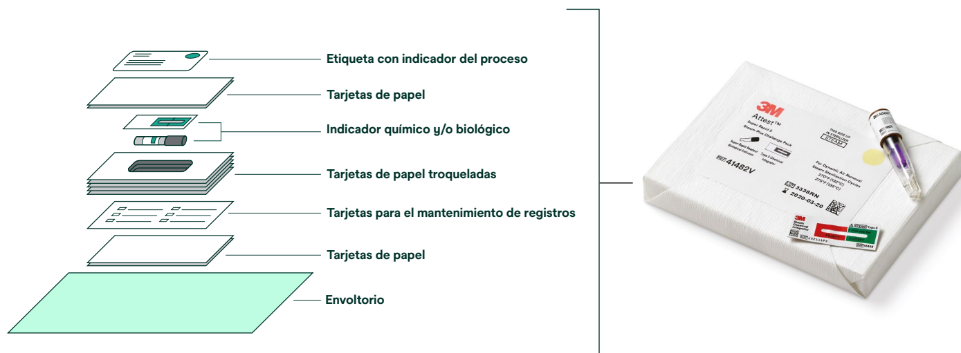
Figura 7. Esquema de un ejemplo de paquete de desafío de base porosa, 3M™ Attest™ Paquete de desafío Super Rapid 5 Steam-Plus 41482V
